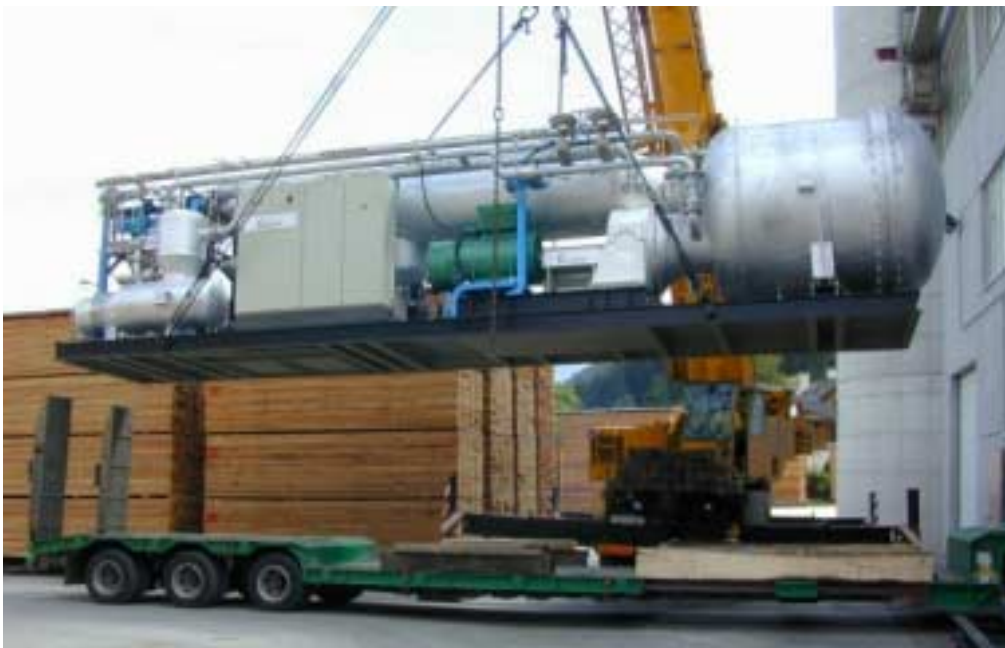
Abbildung 5: Bild der auf einem Containerrahmen vormontierten ORC-Anlage beim Antransport
